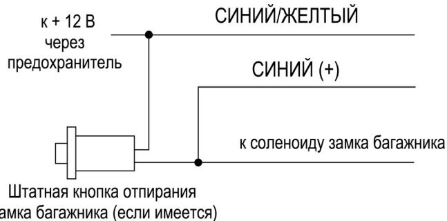
**ПОДСОЕДИНЕНИЕ ДОПОЛНИТЕЛЬНОГО Н.З. РЕЛЕ БЛОКИРОВКИ ДВИГАТЕЛЯ**
