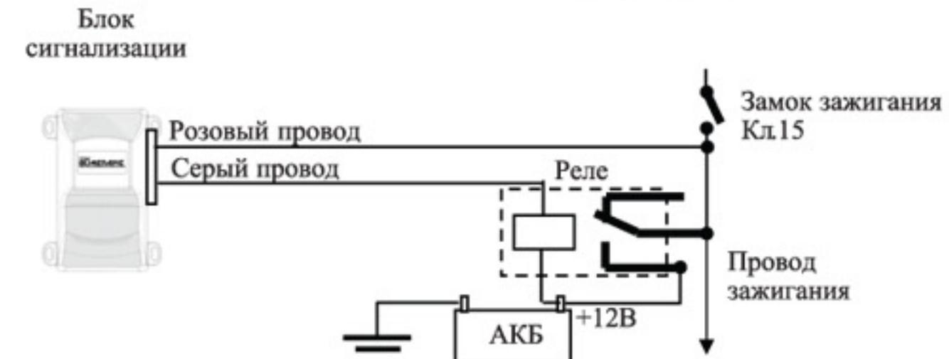
**Подключение нормально разомкнутого реле блокировки**
