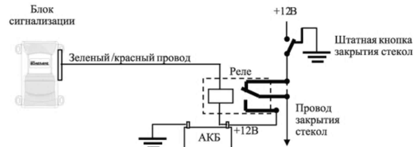
**Подключение дополнительного канала 1 для реализации функции “Поддержка зажигания”**
