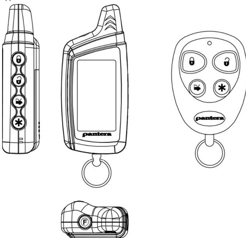
5-кнопочный брелок-передатчик с 2-сторонней связью и ЖК-дисплеем позволяет управлять всеми функциями системы. Помимо этого, каждый раз при использовании данного передатчика система будет посыпать специальные сигналы, подтверждающие исполнение той или иной команды (**“обратная связь”**). В результате на ЖК-дисплее 5-кнопочного брелока будет появляться соответствующая индикация, а встроенный в брелок-передатчик миниатюрный динамик будет подавать соответствующие звуковые сигналы подтверждения.
