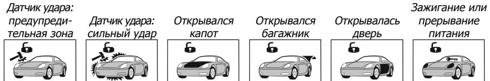
Чтобы повторно узнать причину тревоги, нажмите кнопку I брелка. Причина тревоги будет храниться в памяти системы до включения зажигания или следующего включения охраны.
