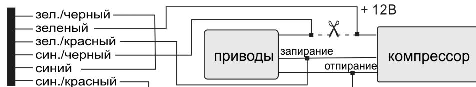
**Примечание:** в случае подключения к системе с компрессорным управлением необходимо запрограммировать Функцию №11 "Длительность импульса на замки" = 4 сек.
