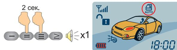
Смена режимов работы происходит длительным двухсекундным нажатием кнопок II+III брелока-коммуникатора в следующем порядке: (функция включена, режим 1) > (функция включена режим 2) > (функция выключена) > (функция включена, режим 1) и т. д.
