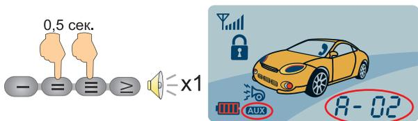
**Включение дополнительного канала:**
