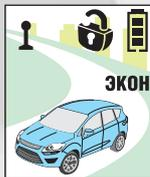
В этом состоянии функции передатчик будет управлять системой, но сигналы подтверждения встроенным динамиком (и/или вибратором) подаваться не будут. Индикация смены состояний системы (например, 3-х кнопочным передатчиком или при автоматических постановках) на дисплее передатчика сохранится. При срабатывании системы сигналы оповещения встроенным динамиком и/или вибратором будут включаться.
