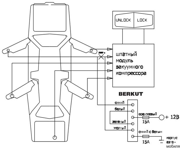
**СХЕМА УПРАВЛЕНИЯ ДОПОЛНИТЕЛЬНЫМИ ЭЛЕКТРОПРИВОДАМИ**
