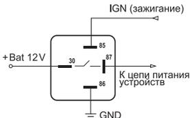
Схемотехника реле обеспечивает его работоспособность в любых вариантах подачи питания на контакты реле. В случае, когда невозможно обеспечить постоянное питание реле по цепи коммутации, 30 сек задержка автоматической постановки на "ОХРАНУ" (ARM) не выполняется. В этом случае состояние "ОХРАНА" (ARM) наступает сразу при включении зажигания или подаче питания на реле.
