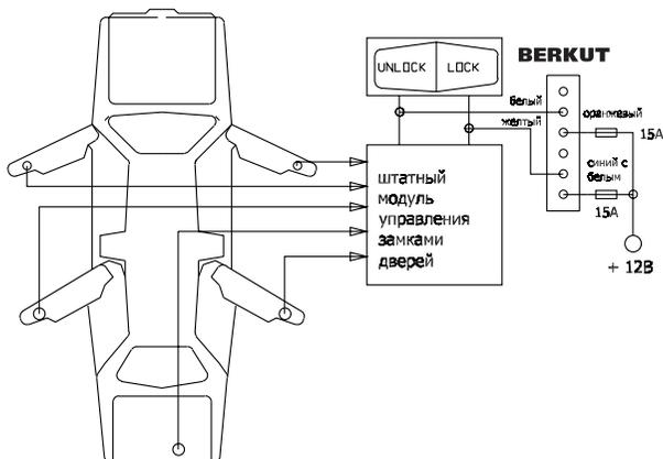
При установке системы в таких автомобилях (большинство легковых автомобилей марки «Дженерал Моторс») темно-зеленый и темно-синий провода запираания/отпирания дверей автомобиля не используются.
