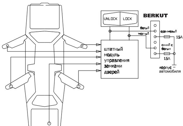
При установке системы в таких автомобилях (большинство автомобилей японского производства) темно-зеленый и темно-синий провода заперения/отпирания дверей автомобиля не используются.
