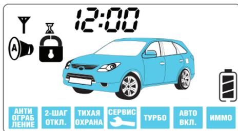
**i** Если двери, капот, багажник окажутся плохо закрытыми, а также неисправен один из кнопочных выключателей дверей, капота, багажника, то сигнализация предупредит об этом 4 звуковыми сигналами и 4 вспышками габаритов (смотрите раздел "Самодиагностика при включении режима охраны").
