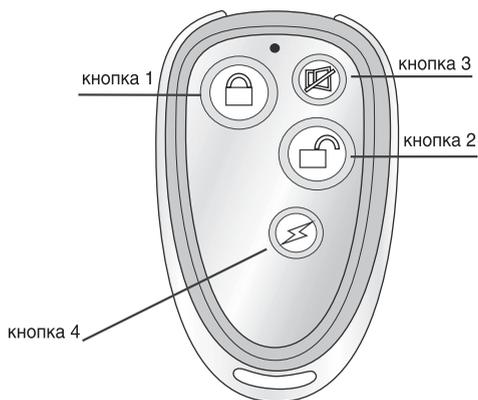
Миниатюрный радиопередатчик, питающийся от 12 вольтовой батарейки (A27), которой хватает примерно на 2 года эксплуатации. Существенное снижение дальности приема системой команд передатчика говорит о необходимости замены батарейки. На пульте расположены четыре кнопки управления и индикаторный светодиод. Алгоритм формирования и передачи управляющих команд идентичен двунаправленному пульту управления. Однонаправленный пульт предназначен только для управления сигнализацией.
