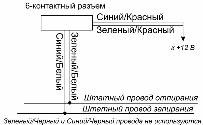
Схема 2. 3-проводная система с положительной полярностью (большинство автомобилей GM)
