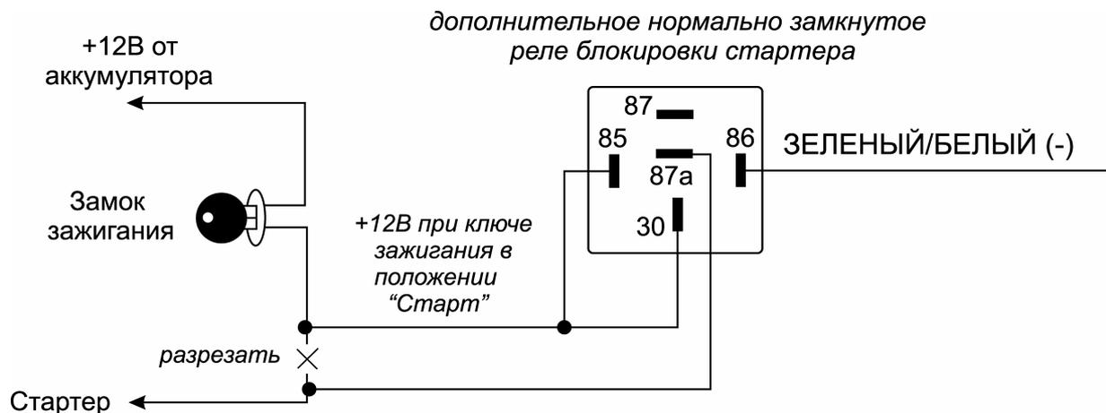
**Внимание!** Дополнительное реле блокировки стартера должно быть подключено к цепи включения стартера между замком зажигания и местом подсоединения Фиолетового провода 6-контактного силового разъема системы. Если используется блокировка цепи зажигания, то данное реле должно быть подключено к проводу, идущему от замка зажигания, между замком зажигания и местом подключения Розового провода 6-контактного силового разъема системы.
