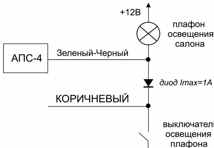
2. Рекомендуемая схема подключения Коричневого провода системы ("отрицательный триггер двери") к проводке автомобилей ВАЗ семейств 2110 и 2115, оснащенных иммобилайзерами АПС-4:
