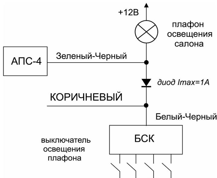
3. Рекомендуемая схема подключения Зеленого/Черного провода системы ("отрицательный триггер капота") к подкапотной лампе автомобилей ВАЗ семейств 2109, 2115, 2123 и Темно-Зеленого провода системы ("отрицательный триггер багажника") к лампе освещения багажника автомобилей ВАЗ семейства 2115:
