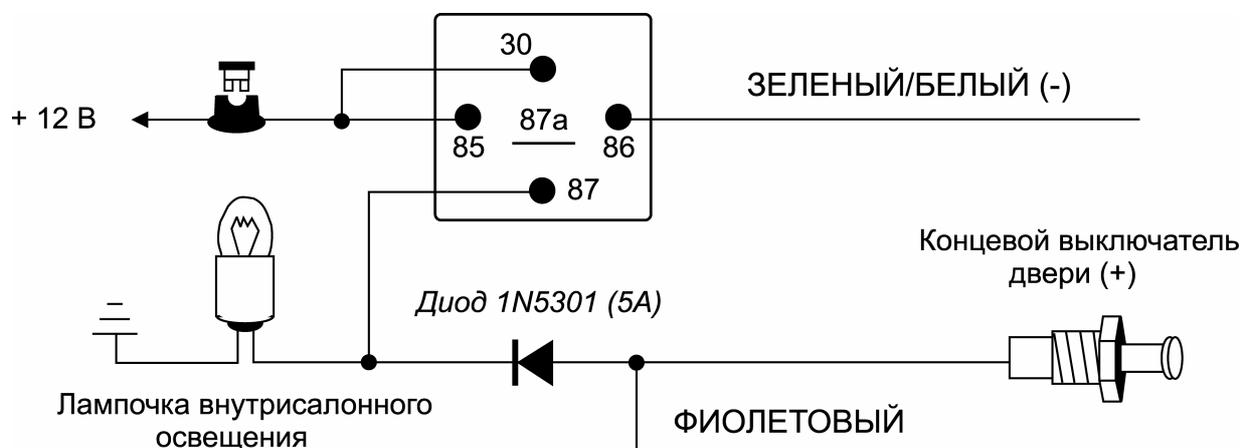
**Внимание! Обязательно** используйте диод для изолирования цепи управления внутрисалонным освещением от цепи триггера двери. В противном случае не сможет правильно работать функция пассивной постановки на охрану и функция автоматической повторной постановки системы в режим охраны.
