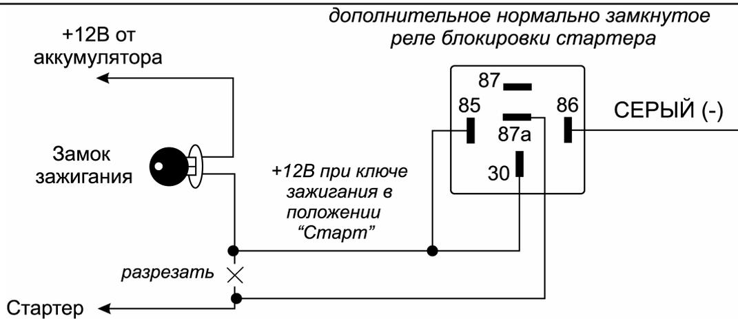
3) Серый провод системы может быть запрограммирован как **“отрицательный выход для управления пейджером”** (программируемая функция # 2.6). В этом случае он уже более не будет замыкаться на “массу” при нажатии кнопки **AUX** передатчика. Вместо этого Серый провод будет замыкаться на “массу” только при срабатывании системы.
