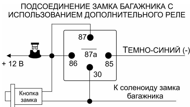
**Подсоединение:** Подсоедините Темно-Синий провод к контакту # 85 дополнительного 30А реле, подсоедините контакт # 86 реле к +12В. Подсоедините остальные контакты реле как показано на схеме.
