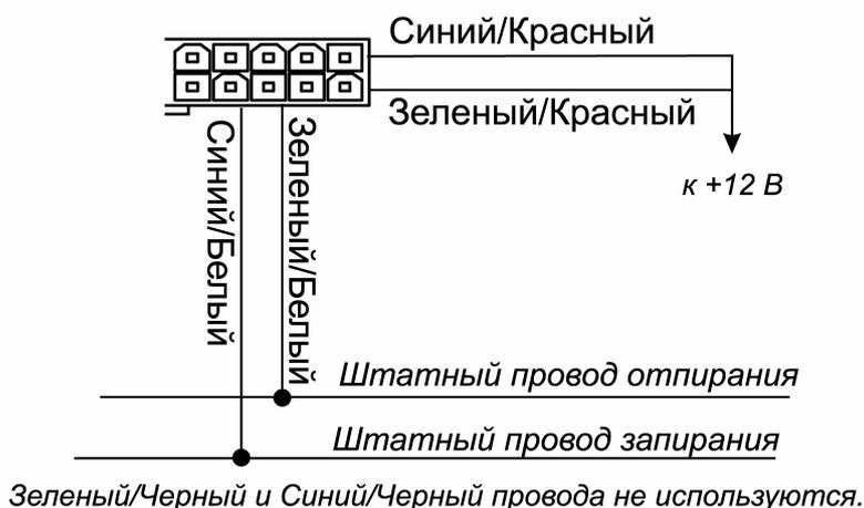
Схема 3. 5 (4) проводная система с переменной полярностью (большинство автомобилей Ford и Chrysler)
