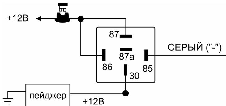
**Подсоединение:** Подсоедините Серый провод к проводу отрицательного триггера дополнительного пейджера. В том случае, если пейджер управляется положительным триггером, используйте дополнительное реле, как показано на схеме.
