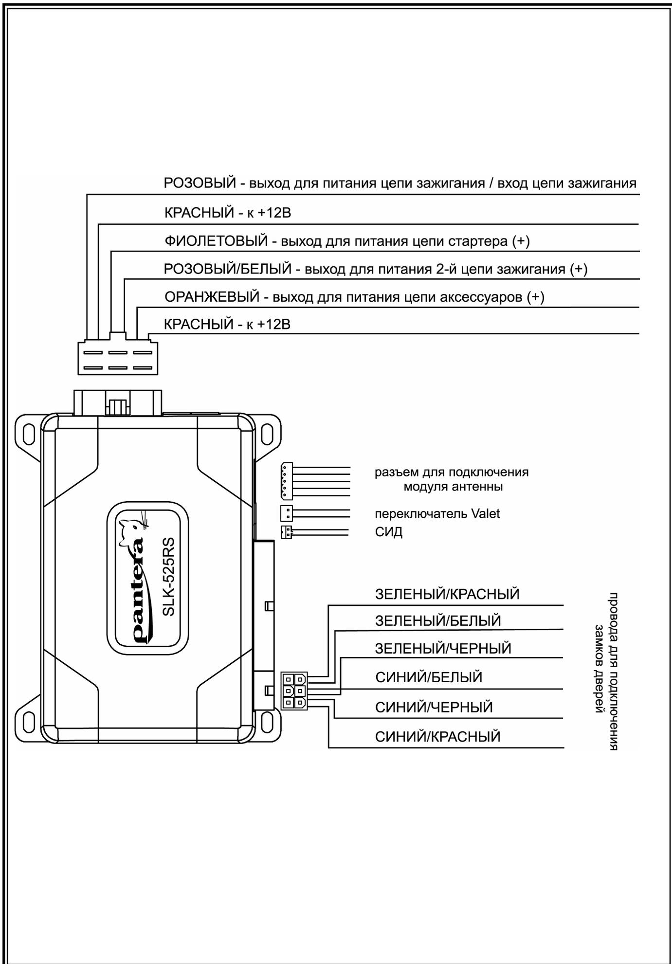
Схема 1. 3-проводная система с отрицательной полярностью (большинство японских автомобилей)
