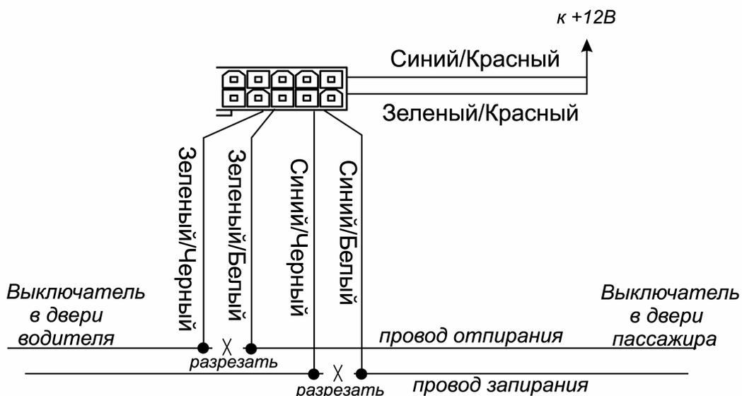
Схема 4. Вакуумная система центрального замка (Mercedes-Benz и Audi)
