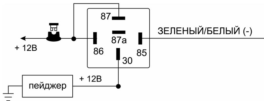
**Подсоединение:** Подсоедините Зеленый/Белый провод к проводу отрицательного триггера дополнительного пейджера. В том случае, если пейджер управляется положительным триггером, используйте дополнительное реле, как показано.
