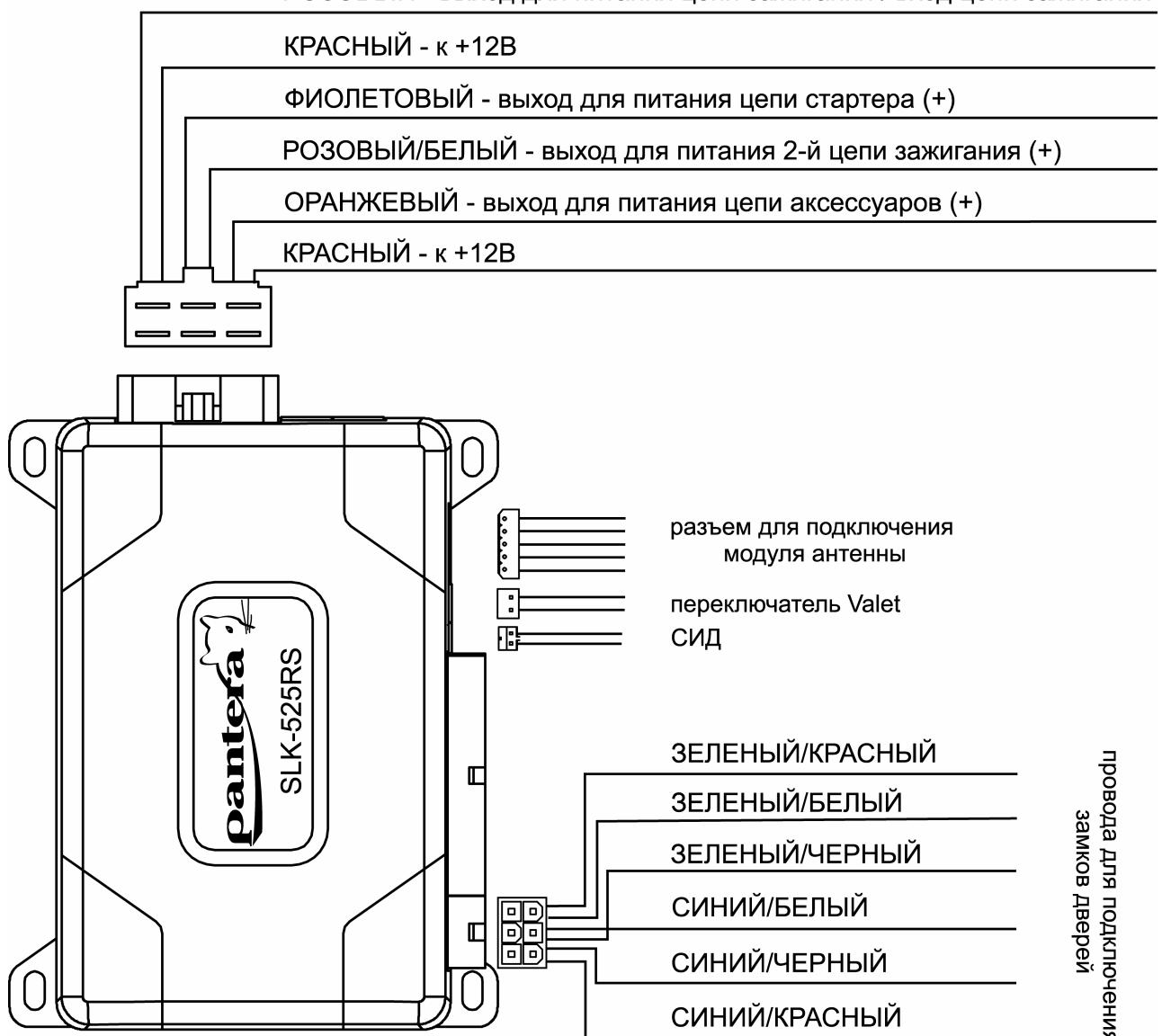
**Схема 1. 3-проводная система с отрицательной полярностью (большинство японских автомобилей)**
