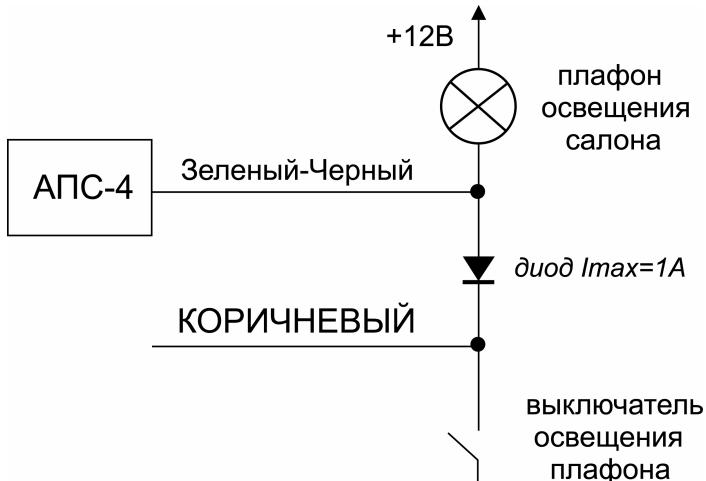
2. Рекомендуемая схема подключения Коричневого провода системы (“отрицательный триггер двери”) к проводке автомобилей ВАЗ семейств 2110 и 2115, оснащенных иммобилайзерами АПС-4:
